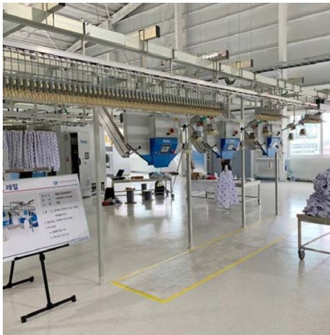
Die Fintec-Systemanlage in Seoul wurde mit drei VarioLoad Aufgabestationen bestückt.
