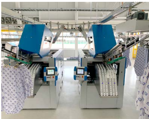
Einlauf der Ware in die Faltschneidemaschinen VarioFold F 85 A.
