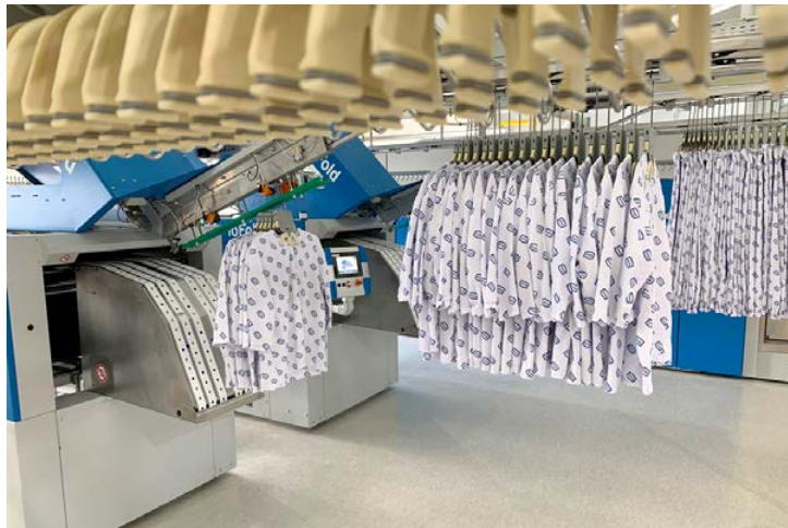
Die flexiblen Vario Automatikbügel sichern den formstabilen Warentransport bis zur automatischen Faltung auf den VarioFold Faltautomaten F 85 A.
