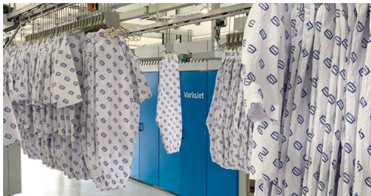
Herzstück der Anlage ist der Tunnelfinisher VarioJet FTS 306 D.
